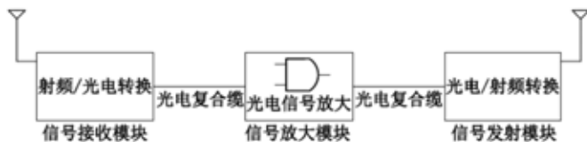
图 3 无线电梯直放站工作原理
