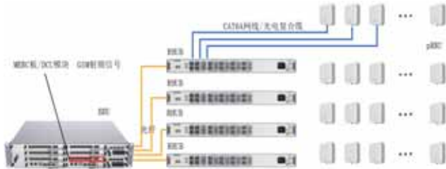
图3 数字化室分覆盖系统网络架构示意图
